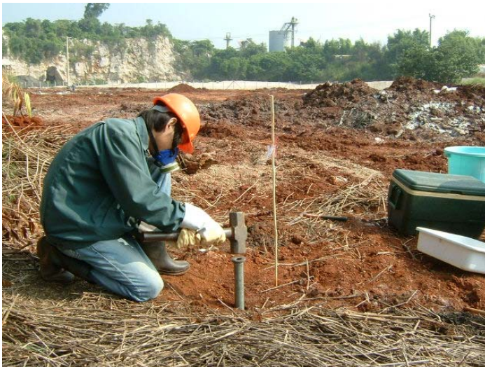
รูปที่ 13 แสดงภาพการเก็บตัวอย่างกากอุตสาหกรรม
